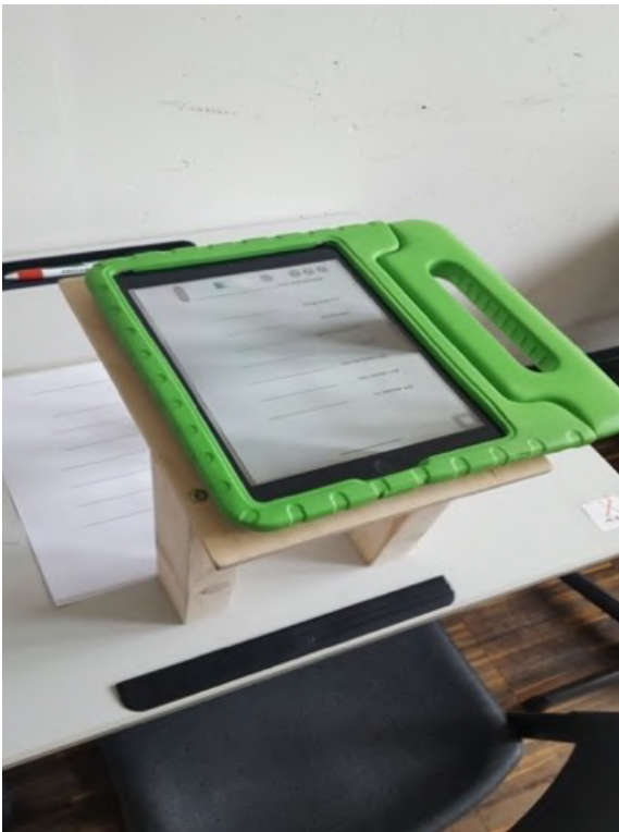
Abb. 8.2.4 Selbstgebaute Halterung für das iPad zum Abfotografieren von Dokumenten
